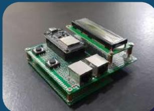
**LANalyst** merupakan produk yang dimiliki oleh Lab untuk mengecek kabel LAN tanpa menggunakan LAN Tester
